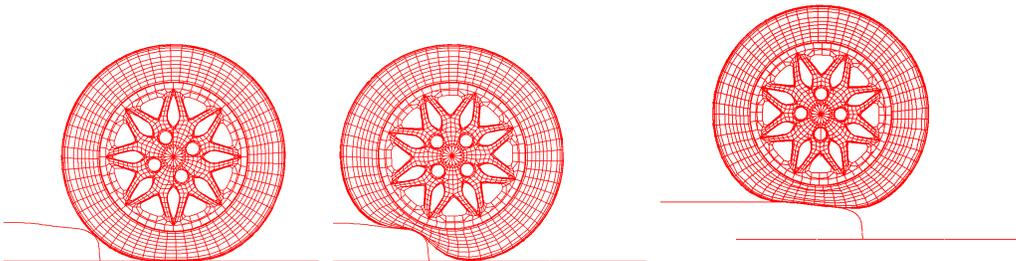
Fig.23 : Tire Deformation (195 Tire)
