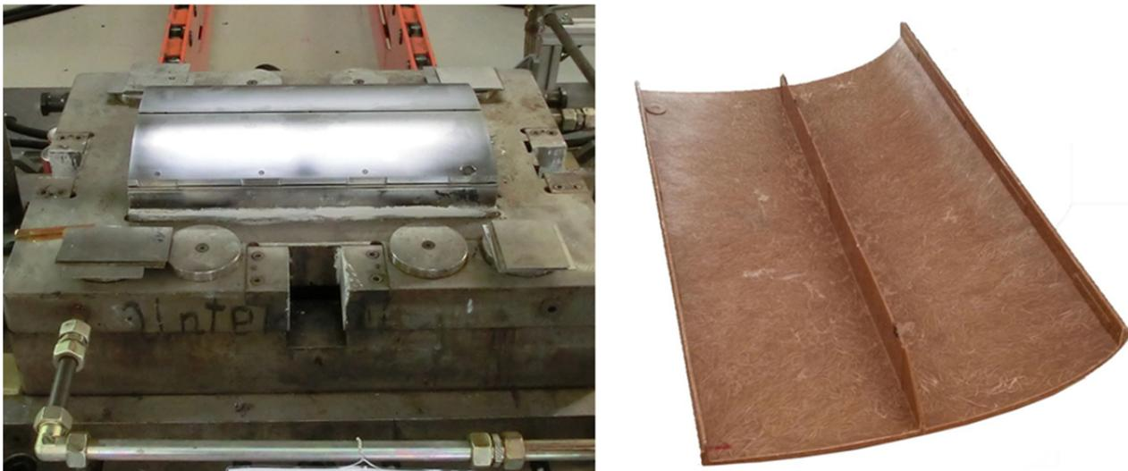
Figure 7 Institut für Verbundwerkstoffe GmbH SMC compression molded automotive spoiler
