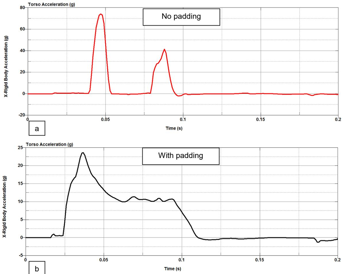
Fig.5: Torso acceleration (g), a) no padding b) with padding
