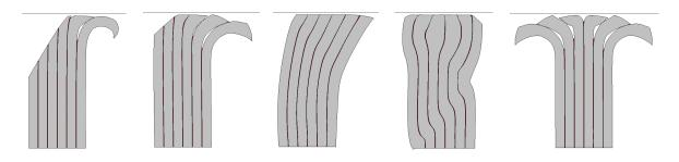
(a) Triangle type-30° (b) Triangle type-45° (c) Triangle type-60° (d) Chevron-type (e) M-type
