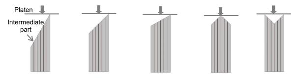
(a) Triangle type-30° (b) Triangle type-45° (c) Triangle type-60° (d) Chevron-type (e) M-type
